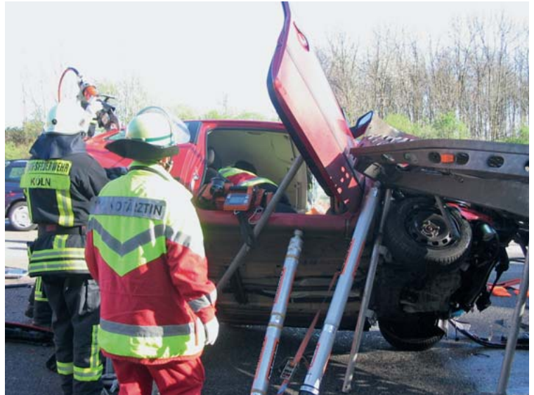
Abb. 12 Sicheres Arbeiten und die Aufnahme von Kräften für die Befreiung des Patienten setzen eine ausreichende Fahrzeugabstützung voraus. Hier: Einsatz des Rettungsdienstpersonals im Fahrzeuginneren und des hydraulischen Rettungsgeräts an der Fahrzeugkarosserie (Bildstelle Feuerwehr Köln).
