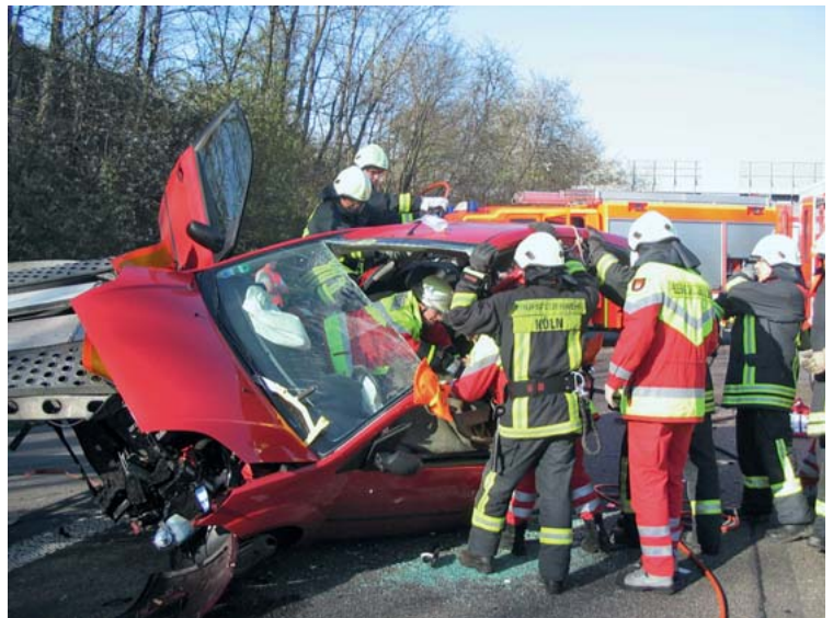
Abb. 13 Nach Durchtrennung der Säulen: Die Dachabnahme ermöglicht die Befreiung des Patienten. Eine notfallmedizinische Versorgung war über die gesamte Dauer der technischen Rettung möglich (Bildstelle Feuerwehr Köln).
