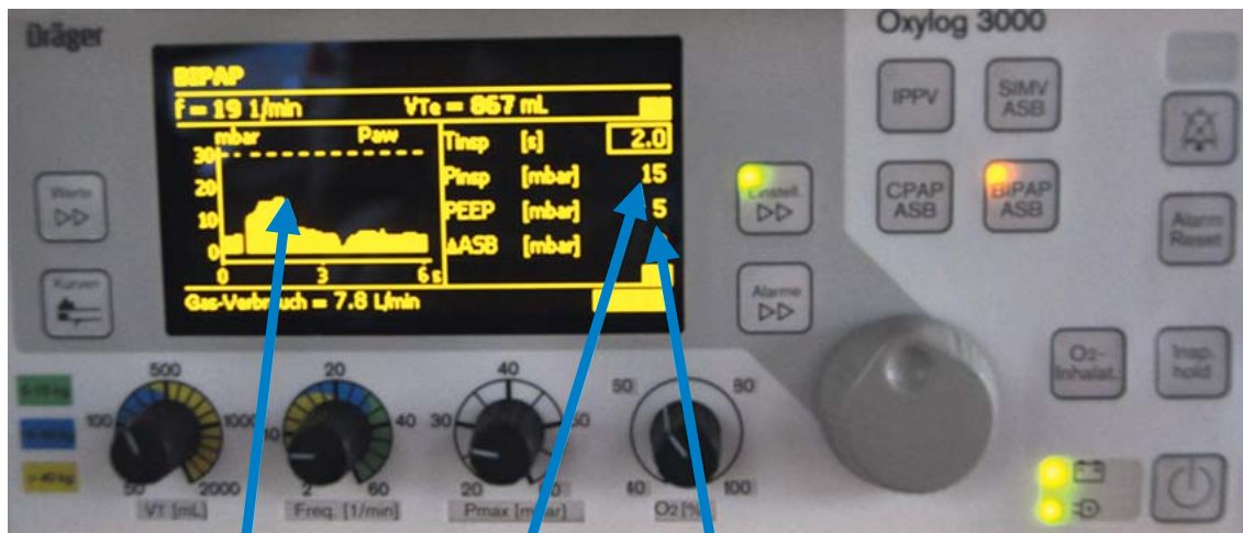
BIPAP: p_{\max} 20 mbar p_1 (insp) 15 mbar p_2 (PEEP) 5 mbar I:E 1:2 (Tinsp 2 s, AF 10/min)
