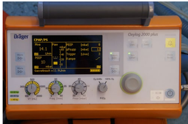
Abb. 5 ◀ Respirator-einstellung zur nicht-invasiven Pressure-support-Ventilation
