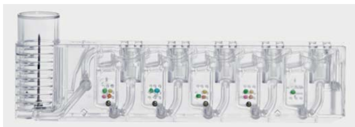
► Abb. 3 Testkassette des ROTEM sigma. Das Blutröhrchen wird auf den Metallspieß gesteckt, anschließend wird das Blut in die Messkammern verteilt. Die bunten Kugeln enthalten u. a. die testspezifischen Aktivatoren und den Heparin-Inhibitor. Nach Aktivierung gelangt das Blut zu den „Cups“ und „Pins“ (Quelle: Tem International GmbH).
