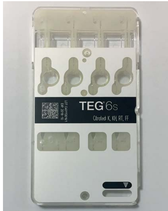
► Abb. 7 Testkassette des TEG 6s. Unten rechts befindet sich eine Öffnung, über die Blut in die Kassette pipettiert wird. In 4 Messkammern werden anschließend scheibenförmige Blutropfen gebildet, die mittels Ultraschall in Bewegung versetzt werden.
