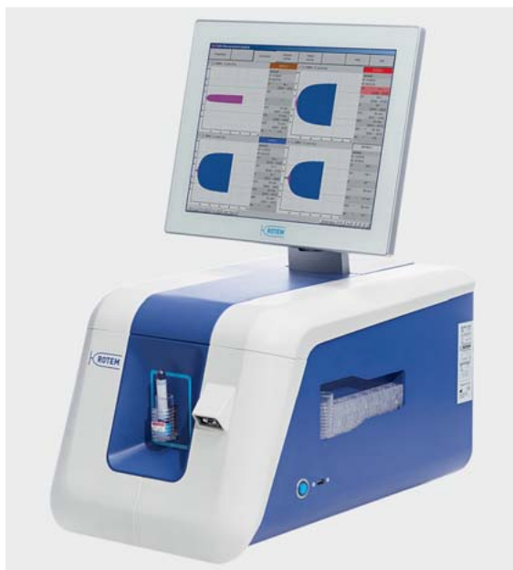
► Abb. 2 ROTEM sigma: Das Blut aus der auf die Testkassette aufgesetzten Spritze wird automatisch eingesogen und anschließend auf 4 Messzellen verteilt. Pipettierarbeiten sind nicht nötig (Quelle: Tem International GmbH).
