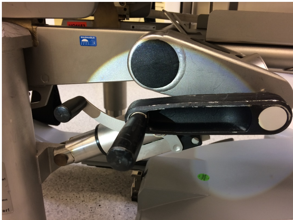
Bild 2: Kurbel ausgeklappt; Armschiene angepasst; Kurbel noch arretiert
