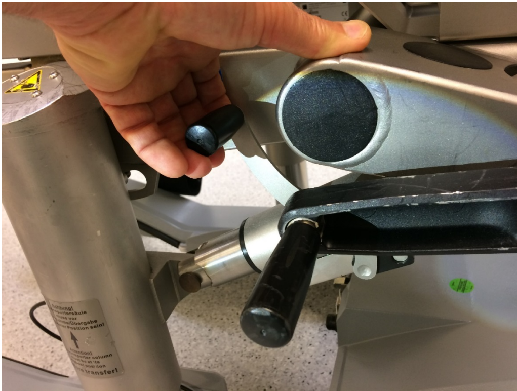
Bild 3: Arretierungshebel nach oben ziehen
