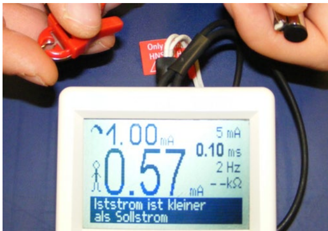
Abb. 3 ◀ Anforderung an einen modernen Stimulator: Durch den hohen Widerstand an der Haut wird der eingestellte Strom (1,0 mA) nicht generiert; der Stimulator gibt Alarm. Die Anzeige ist eindeutig und zeigt den fließenden Strom an (0,57 mA)
