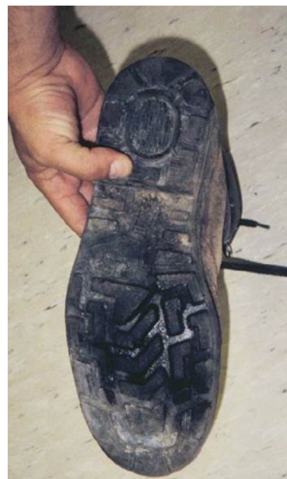
Abb. 5 ▲ Durch Stromfluss auf der Kontaktfläche fast eingeschmolzener, wie neu wirkender Sicherheitsschuh (s. schwarzen Schuhabdruck auf dem Asphalt in Abb. 2). (Aus [2])
